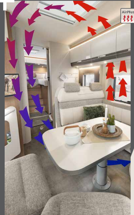
Het AirPlus systeem verhindert condensvorming achter de bovenkasten
