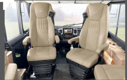
Nog meer reiscomfort: luchtgeveerde SKA-stoelen incl. stoelverwarming en -ventilatie (optioneel bij integraal)
