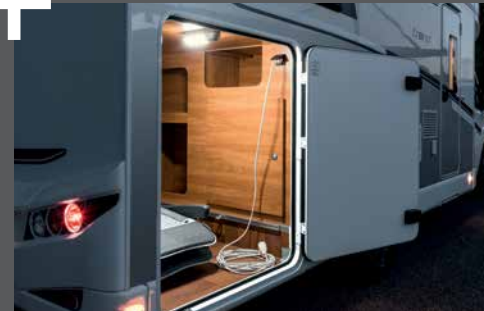
Verlichting en 230V-stopcontact in de garage
