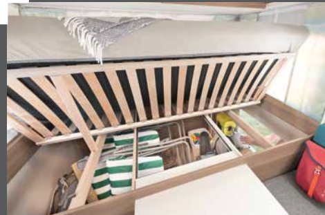
De speciale lattenbodems kunnen recht op worden gezet voor een optimaal gebruik van de opslagruimte
