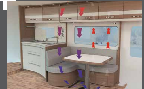
AirPlus – perfecte luchtcirculatie in het interieur en ventilatie aan de achterkant van bovenkasten en aanrecht
