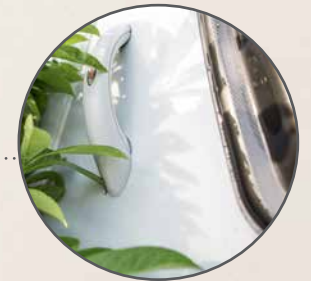
De voor- en achterzijde en het dak zijn gemaakt van hagelbestendig GFK-materiaal
