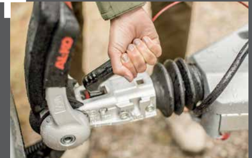
Veiligheid in serie: AKS anti-slingkoppeling
