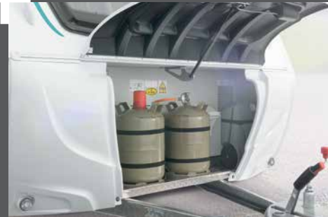
Opbergkast voor gasflessen 2 x 11 kg met bodem van rotvrij, stabiel aluminium traanplaat
