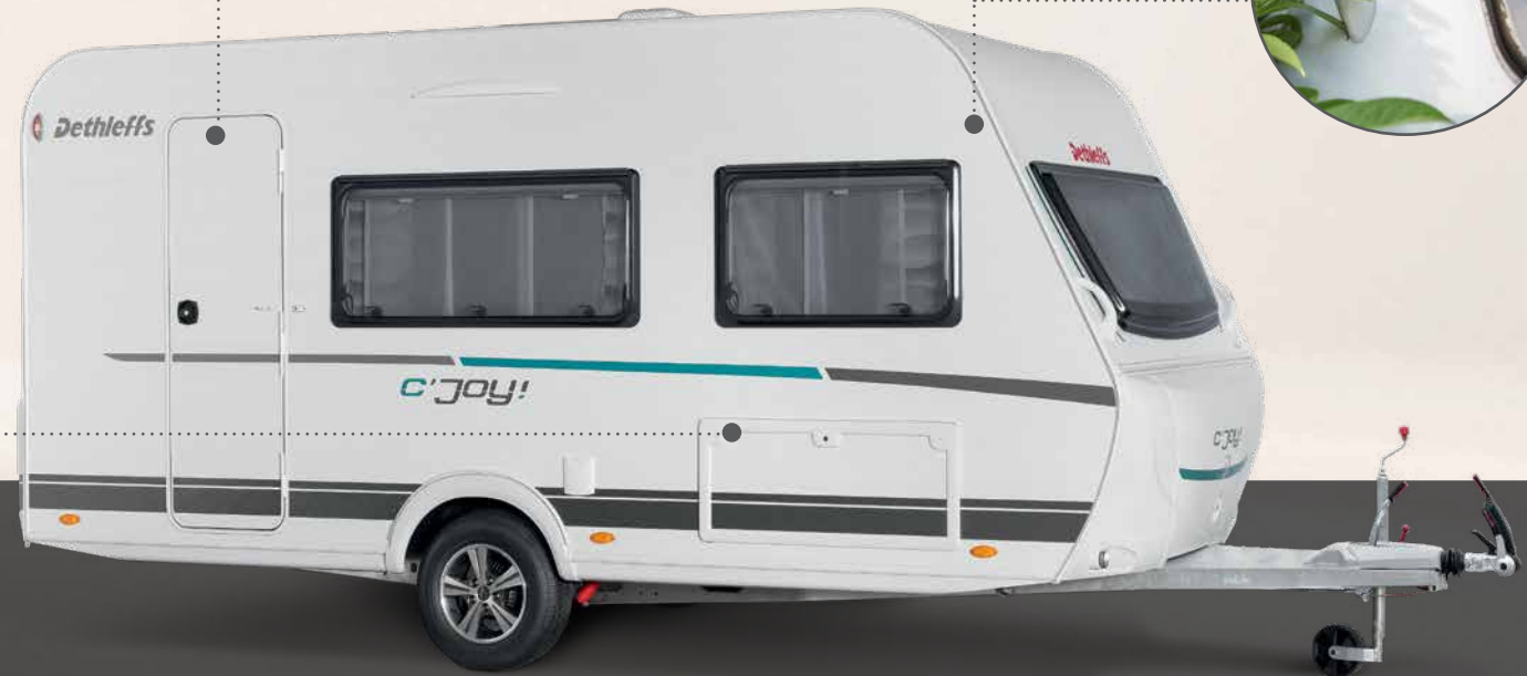
De voor- en achterzijde en het dak zijn gemaakt van hagelbestendig GFK-materiaal
