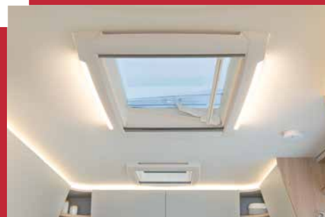
Het grote panoramadakluik met LED-verlichting laat licht en lucht in het voertuig binnen (90 Years-pakket)
