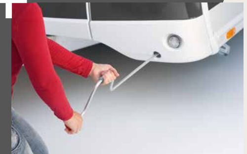
Slimme toegang voor het uitdraaien van de uitdraaistempelen
