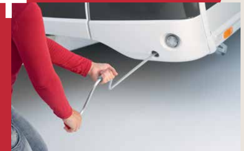
Slimme toegang voor het uitdraaien van de uitdraaistempelen
