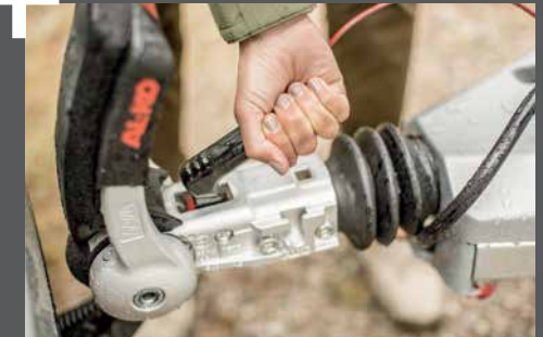
Veiligheid in serie: AKS anti-slingkoppeling
