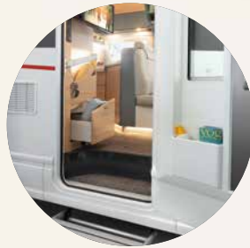
70 cm brede opbouwdeur met verlaagde instap
