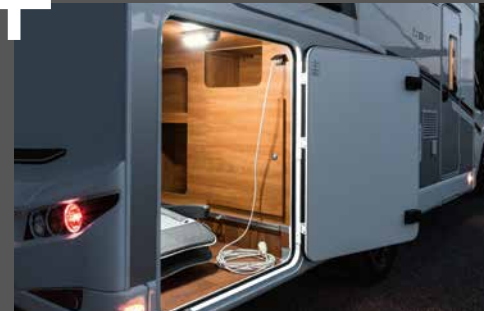
Verlichting en 230V-stopcontact in de garage
