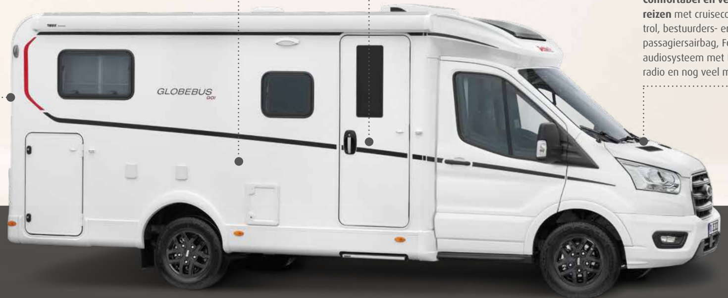
Dak, achterzijde en zijwanden van sterk GFK-materiaal.
