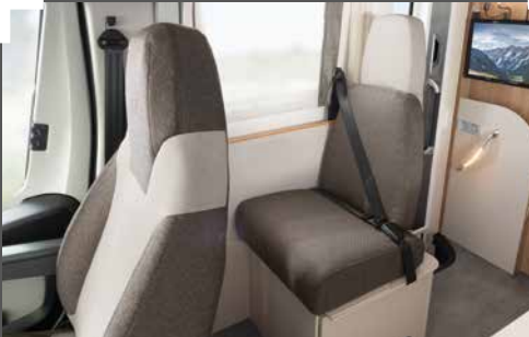
Bij de indelingen DBL en EBL is een ombouw van de zitbank in lengterichting tot een zitplaats met veiligheidsgordel mogelijk
