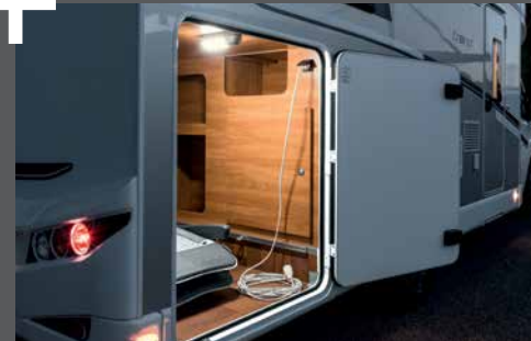
Verlichting en 230V-stopcontact in de garage
